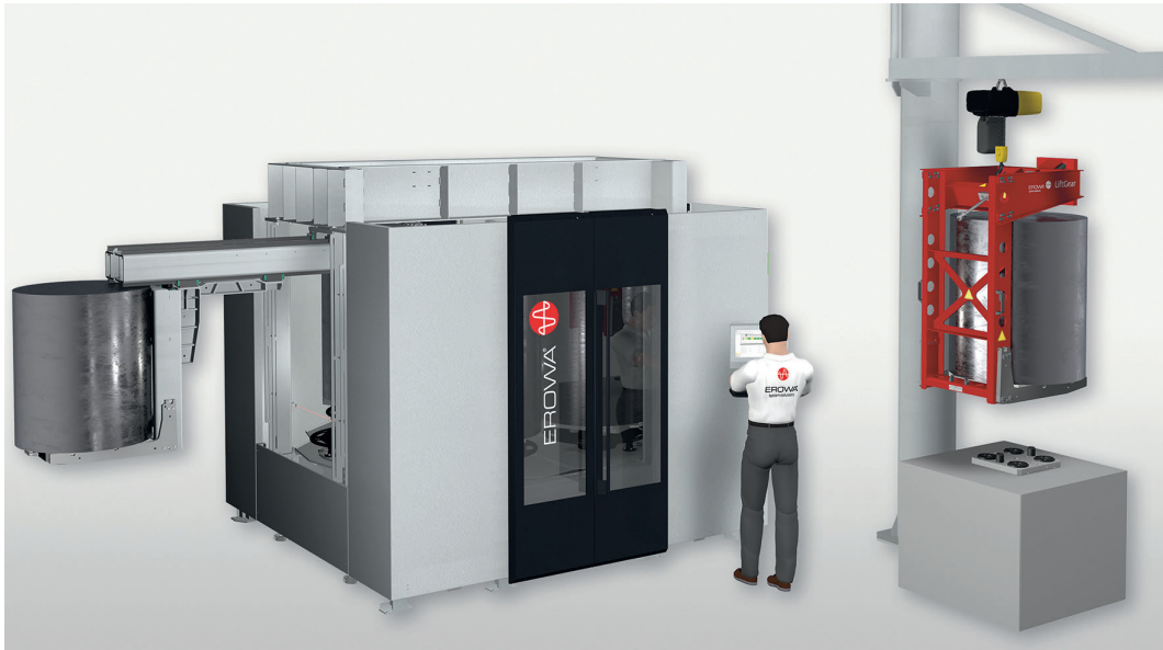
1 Robot Easy 800 zeigt seine Stärke beim Beladen von schweren Werkstücken bis 800 kg
